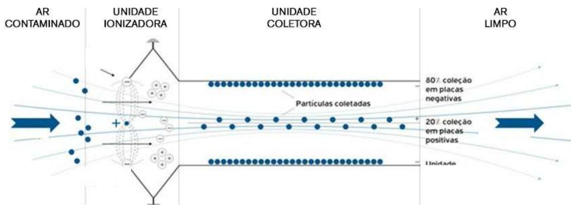
O filtro eletrostático tecnologia Hayashi Brasil geram campos magnéticos capazes de reterem bactérias e vírus e separa micro poluente da ordem de 0,000001 mm, nosso equipamento é compatível com filtros absolutos tipo HEPA | EPA | ULP, alternativa para pressurização e purificação de "salas suprida de AR Condicionadas".
