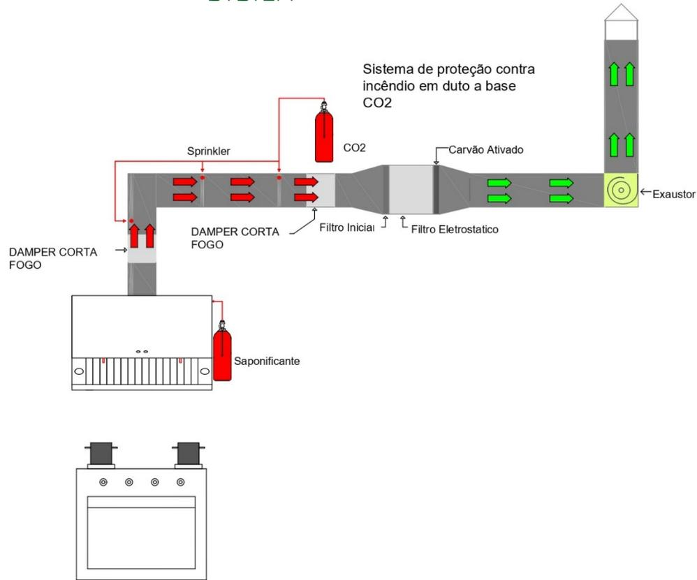
O acionamento do mecanismo é dado quando há um foco de fogo na tubulação, efeito que aciona os sensores liberando imediatamente o gás em de forma de uma cortina de alta densidade (cerca de 1,5 vezes maior que a do ar) através dos difusores para suprimir as chamas, combinando o resfriamento da área protegida e redução de oxigênio dentro do duto, uma vez que o CO<sub>2</sub> desloca o ar e toma seu lugar fazendo que o oxigênio fique em níveis que não possa haver combustão.
