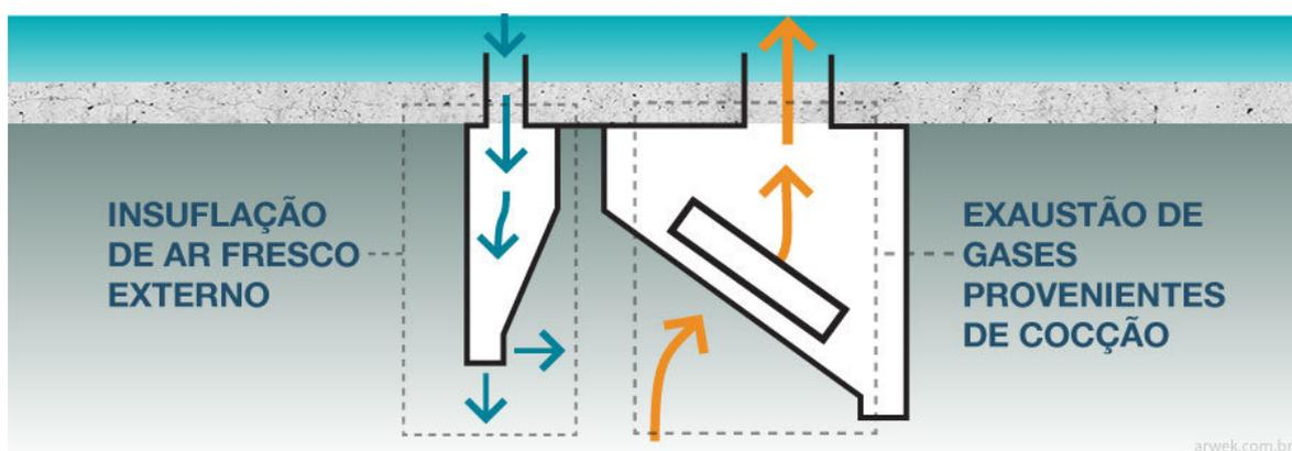
Um dos itens importantes para adequação de um Sistema de ventilação para cozinhas profissionais com a NBR 14518 é o Suprimento do Ar de Compensação, também conhecido por "Make-Up
