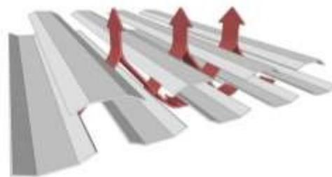
Nota: Os inerciais auxiliam o sistema de combate a incêndio pois proporcionam um efeito corta-chama. A inclinação dos filtros deverá ser o mais próximo possível dos 45° para seu correto funcionamento.
