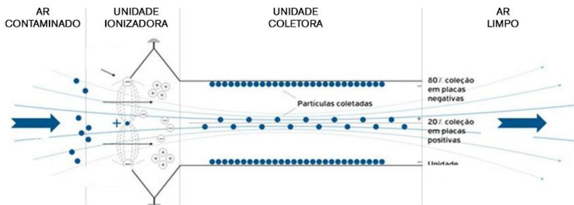
Seu uso é amplamente difundido no controle de poluição em fábricas e cozinhas profissionais que emitem gases e partículas poluidoras à atmosfera. Os módulos podem ser incorporados nas coifas ou em gabinetes externos (precipitadores eletrostáticos).
