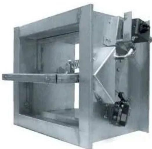
Os dampers corta fogo servem para isolar determinadas zonas contra propagação do fogo em instalações de exaustão e ar-condicionado, além de redes de dutos também pode ser montados em paredes, lajes e o mesmo poderá ser acionado por fusível térmico, solenoides, motor elétrico, pistão pneumático etc.
