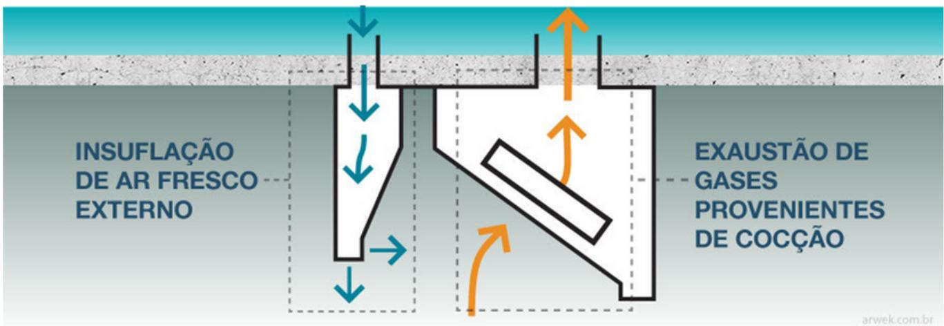
Um dos itens importantes para adequação de um Sistema de ventilação para cozinhas profissionais com a NBR 14518 é o Suprimento do Ar de Compensação, também conhecido por "Make-Up Air".
