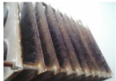
Os módulos eletrostáticos são constituído de um grupo de laminas (positiva e negativa) de material nobre que ao energizar libera trilhões de ions negativos, atuando na quebra das moléculas de gordura as polarizando, e por meio do princípio da estática e da atração de cargas eletricamente opostas os particulados graxos são atraídos para as laminas positivas devolvendo ao ambiente ar ionizado, livre de odores, vírus e bactérias conforme ilustrado na figura abaixo.
