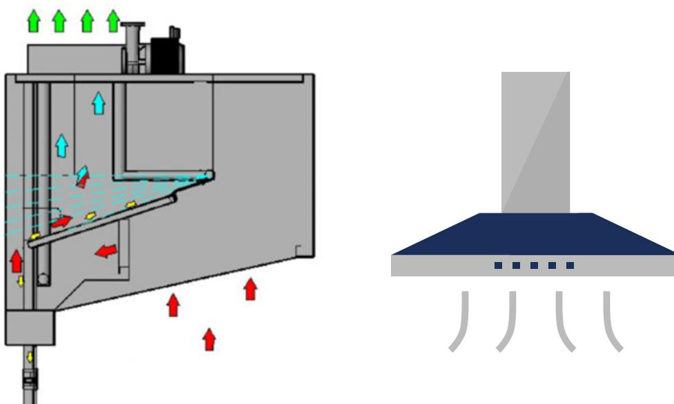
Sempre pensamos em inovações e soluções sustentáveis por conta disso desenvolvemos um novo sistema no conceito de coifa lavador com hidro filtro tipo "PASS THROUGH" maximizando a eficiência do equipamento e minimizando a manutenção e com um novo sistema de prevenção de entupimento dos bicos aspersores. Seu funcionamento automatizado sem contato manual permite maior eficiência durante o processo de lavagem do ar da exaustão. Desta forma, a economia de energia, água e detergente são maiores,
