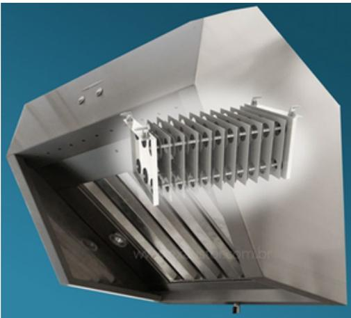
Captor que incorpora dispositivo que promovem a polarização das partículas contidas no ar que são atraídas por placas com polaridade oposta, liberando o ar purificado livre de fumaça e odores. Podem ser instalada encostada na parede ou central (Ilha).
