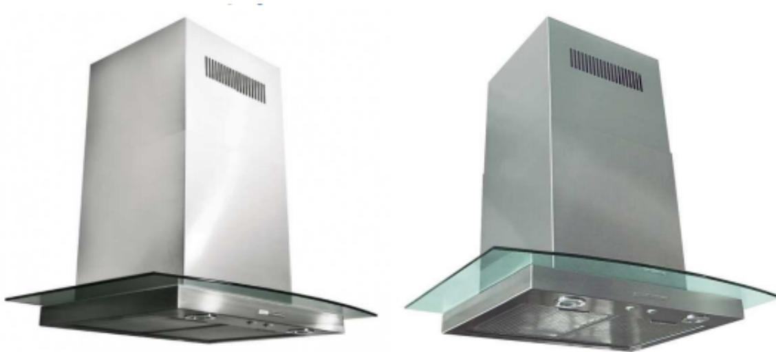
Coifa Residencial, para cooktop ou fogão 4 queimadores doméstico a gás, ou elétrico. Com dois dutos, que deslizam um dentro do outro, sendo o de baixo, onde tem todo o sistema, vai o motor, conjunto trafo e módulo filtrante, e o duto de cima, é por onde o ar retorna limpo ionizado, de volta ao ambiente.
