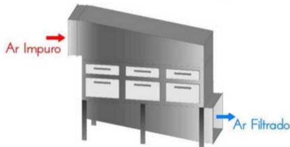
O filtro eletrostático Hayashi Modelo Vertical é semelhante ao modelo horizontal, sendo montado em gabinete metálico de aço carbono tratado contra corrosão. Possui base de apoio, dreno de limpeza de gordura e aberturas para conexão de dutos, com a vantagem de se adaptar a espaços verticais restritos. A disposição interna dos filtros evita o "by-pass" do ar. O filtro consiste em dois estágios de filtração: um pré-filtro metálico inercial e um estágio eletrostático.
