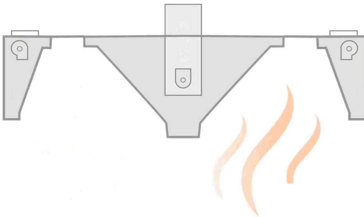
O Módulo de Compensação de Ar da Hayashi é um equipamento que pode ser acoplado aos nossos captadores da linha 20-20 que irá captar o ar externo, tratá-lo e injetá-lo através de uma cortina perimetral nas bordas do módulo insuflador, deforma a confinar o fluxo de fumaça e aumentar a eficiência do sistema de exaustão.
