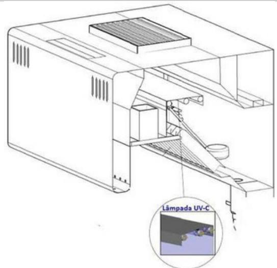
As Lâmpadas UV-C duram milhares de horas, consome pouca energia e gera ions negativos que duram ate 10 segundos, voltando a se tornar oxigênio. Este processo depura o ar com alto eficiencia.
