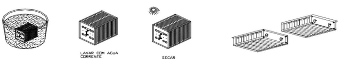
7. Deixar secar completamente, principalmente os isoladores, em temperatura ambiente, ou ainda secá-los ao sol ou em estufa antes de recolocá-los no equipamento. Para serem colocados novamente no local, os módulos devem estar **TOTALMENTE SECOS**.
