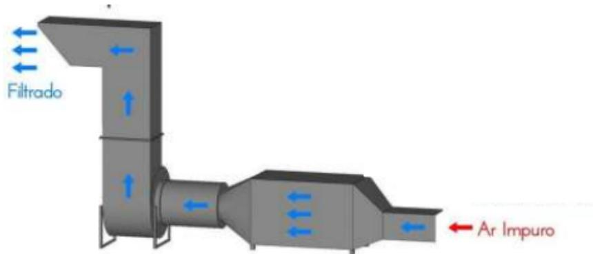
O filtro eletrostático Modelo Horizontal é instalado em um gabinete metálico compacto, feito de aço carbono tratado para resistência à corrosão. Ele possui uma base de apoio, um dreno de limpeza de gordura e aberturas para conexão de dutos. Sua característica principal é adaptar-se a espaços horizontais restritos. A disposição interna dos filtros impede o "by-pass" do ar. O filtro consiste em dois estágios de filtração: um pré-filtro metálico inercial e um estágio eletrostático.
