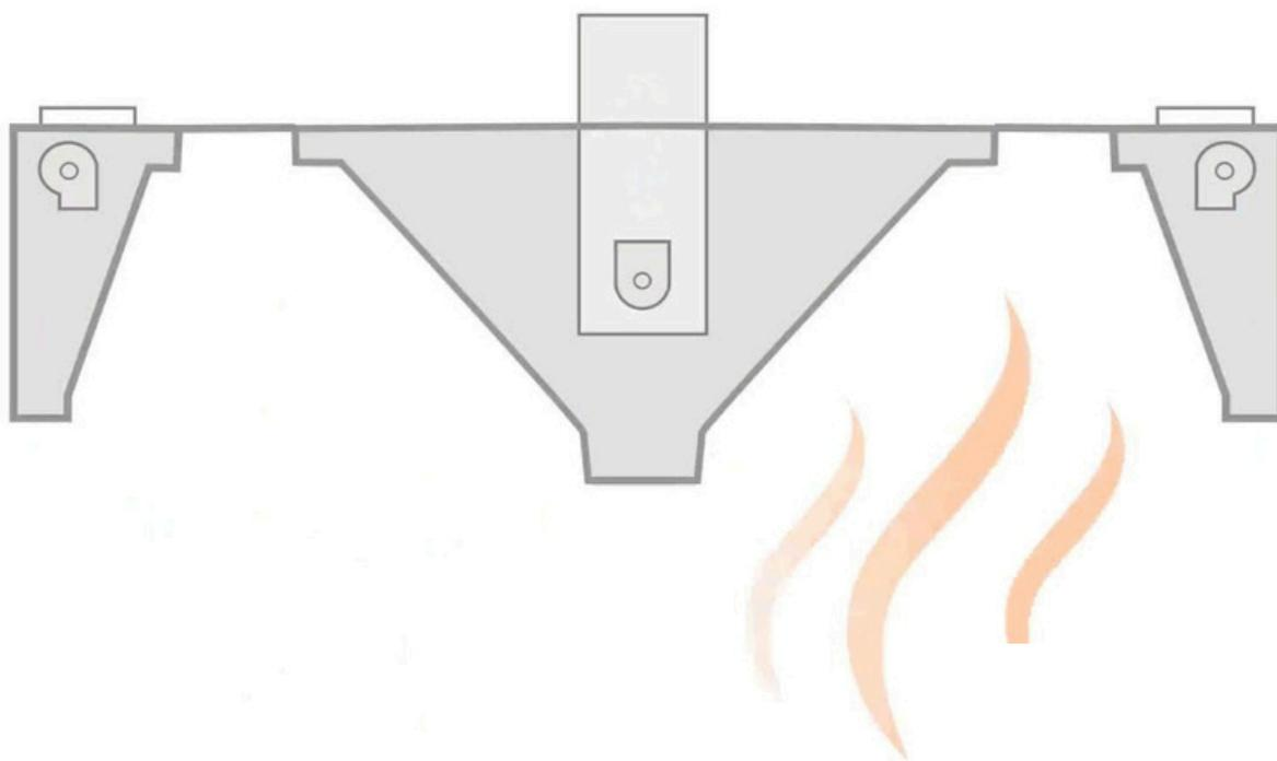
O Módulo de Compensação de Ar da Hayashi é um equipamento que pode ser acoplado aos nossos captosres da linha 20-20 que irá captar o ar externo, tratá-lo e injetá-lo através de uma cortina perimetral nas bordas do módulo insuflador, deforma a confinar o fluxo de fumaça e aumentar a eficiência do sistema de exaustão.
